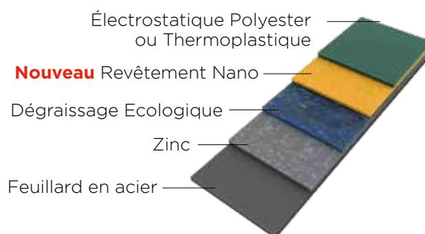
Le **revêtement NANO** est une technologie spéciale qui augmente les performances d'adhérence du revêtement à la surface métallique et crée des pores de tailles NANO. Grâce à cette nouvelle technologie, la peinture statique adhère mieux au métal et forme une couche protectrice.
