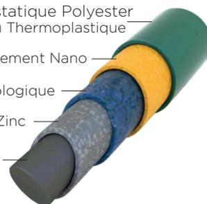
Le **revêtement NANO** est une technologie spéciale qui augmente les performances d'adhérence du revêtement à la surface métallique et crée des pores de tailles NANO. Grâce à cette nouvelle technologie la peinture statique adhère mieux au métal et forme une couche protectrice.
